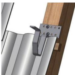
Priskrutkovanie strešného háku na krokve
